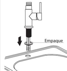
4. En la parte posterior inserte el empaque y enrosque la tuerca para sujetar la llave.
