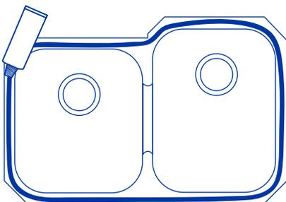
3. Alinee por debajo del agujero de la cubierta el fregadero, ajustando y centrando las tinas. Detenga por unos minutos para que quede sujeto a la encimera con el pegamento.
