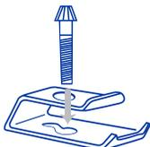
4. Deslice las anclas por el riel de anclado. Ya colocadas apriete con un desarmador plano. Ponga especial atención en el centro y las esquinas del fregadero.
