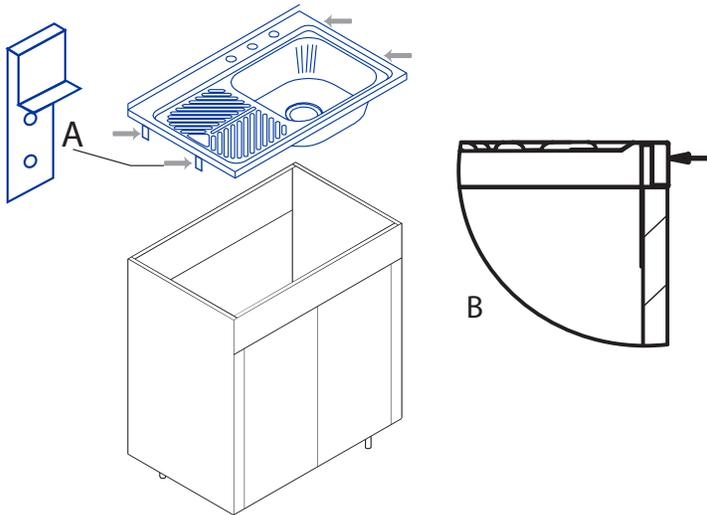
2. Coloqué su fregadero EB sobre el mueble de madera y marque la posición de las anclas.
